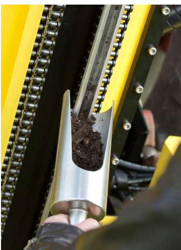
Die Erde wird mit einer Schaufel und einem Schaber aus dem Bohrstock genommen und in die Sammelbehälter gefüllt.
