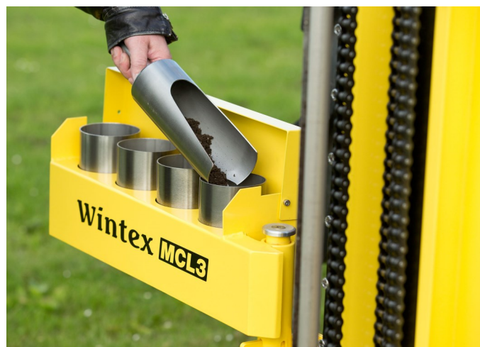
Die Erde wird mit einer Schaufel und einem Schaber aus dem Bohrstock genommen und in die Sammelbehälter gefüllt.
