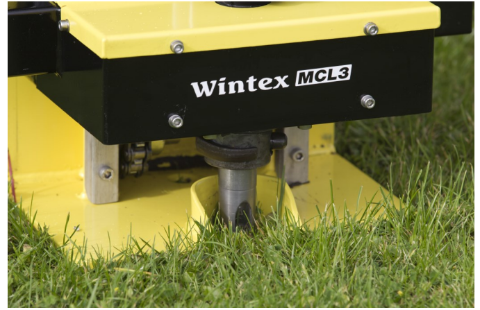
Der Bohrstock geht mit Hilfe eines Hochfrequenzhammers in den Boden.
