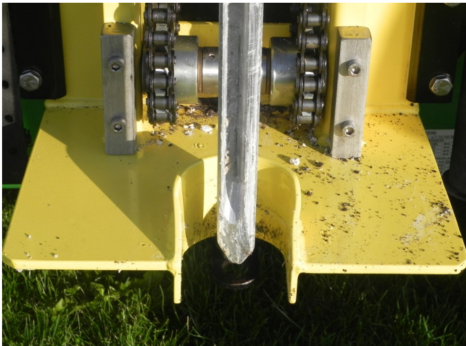
Die Spitze des Bohrstocks ist besonders geformt und gewährleistet gleichartige und repräsentative Bodenproben.
