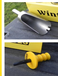
Die Erde wird mit einer Schaufel und einem Schaber aus dem Bohrstock genommen und in die Sammelbehälter gefüllt.
