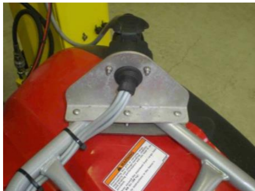
Bauen Sie die Halterung für den 13-poligen Stecker in einer passenden Position dicht am Bodenprobengerät an.
