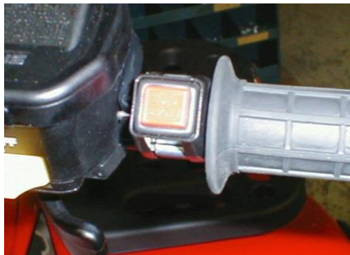
Der Anlassschalter am rechten Handgriff eines Honda ATVs
